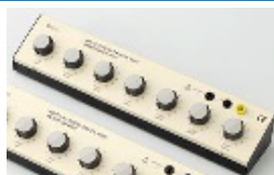
CUTIE INDUCTANȚE BL 07 – CHAUVIN ARNOUX • Domeniu 1 μH ... 10μH • 7 decade • Curent de lucru max 300mA • Selector rotativ
